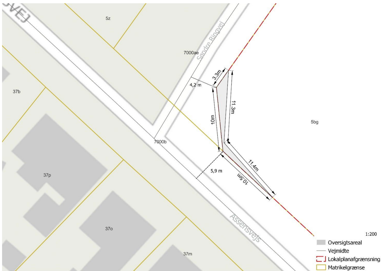
Figur 7, viser det oversigtsareal hvor bebyggelse og beplantning ikke må gives en større højde en 0,8 m.
